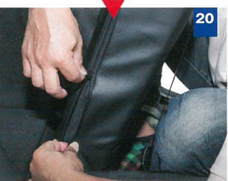
20 突起部を通したあと、側面のファスナーを閉じて背もたれのカバーを固定する。
