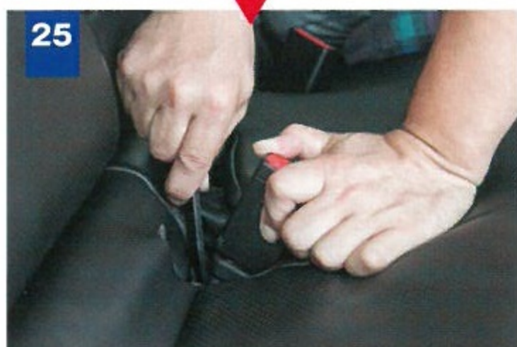
25 座面カバーのシートベルト部をヘラで押し込む。アームレストも元に戻そう。
